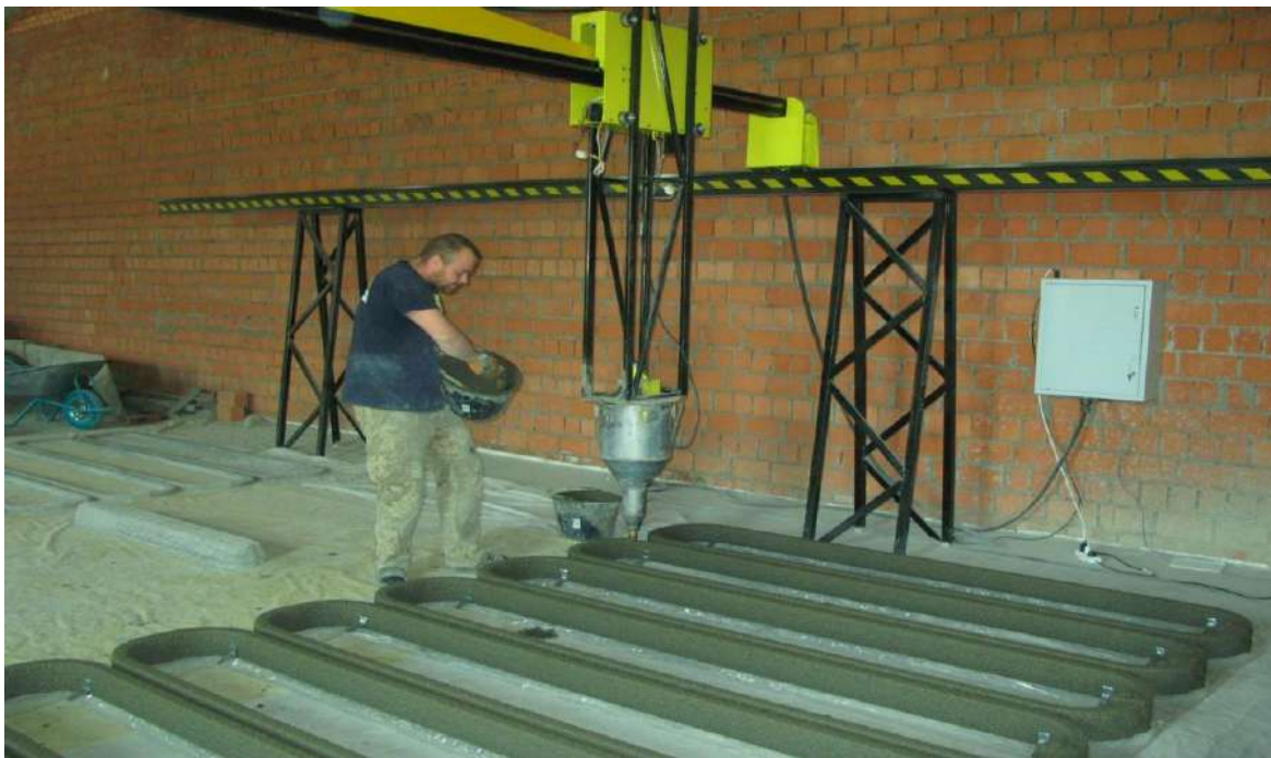
Рис. 1. Виготовлення секцій забору за допомогою 3D-принтера
