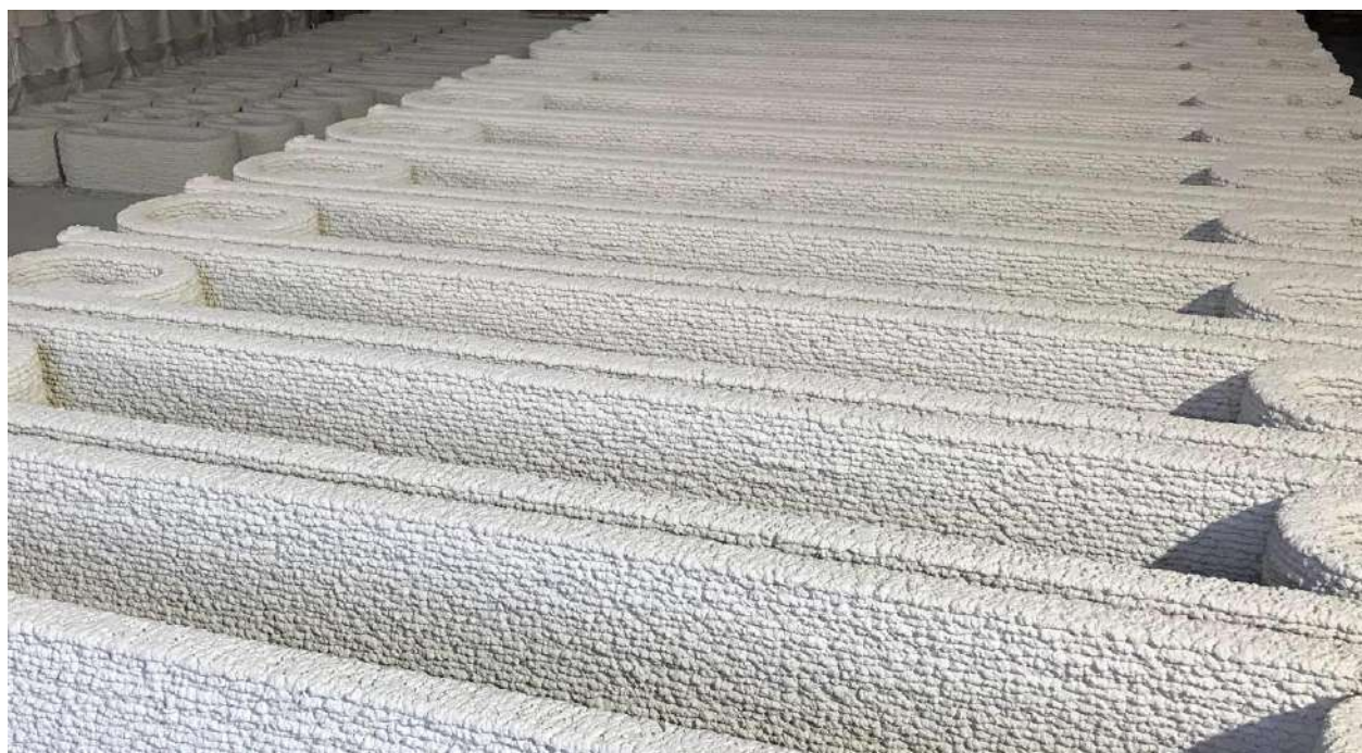
Рисунок 4. Внешний вид бетонных изделий изготовленных с использованием 3D-принтера портального типа
